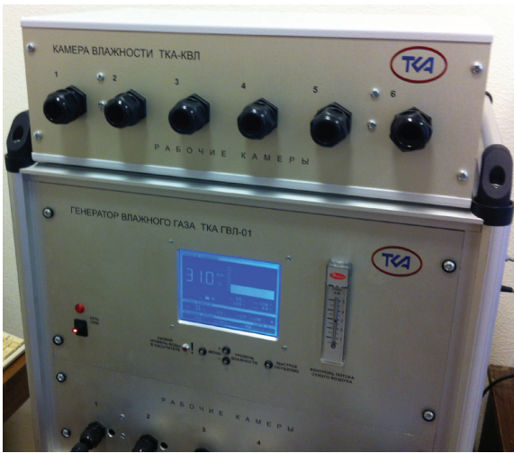
Рис. 4. Камера влажности «ТКА-КВЛ» с 6 рабочими портами
