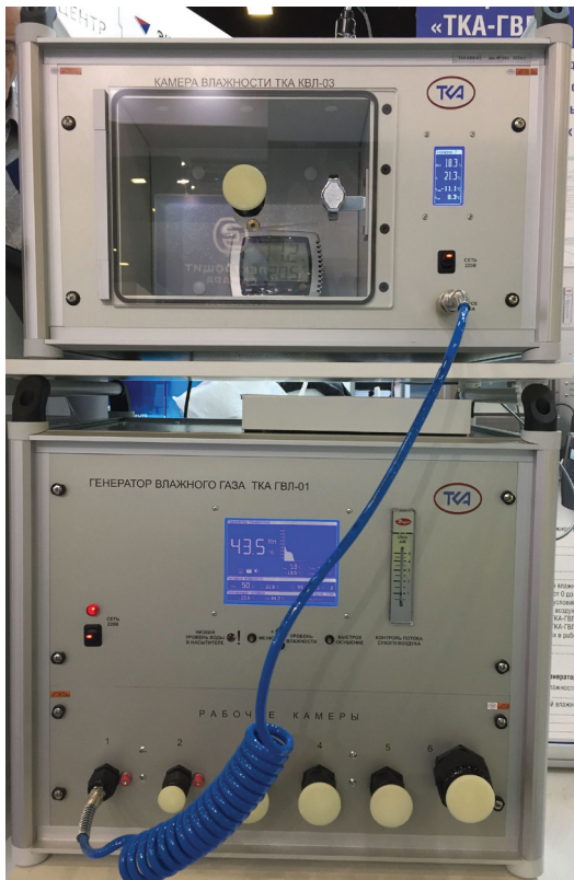
Рис. 6. Камера влажности «ТКА-КВЛ-03» подключена к генератору «ТКА-ГВЛ-01»
