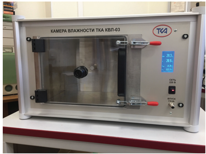
Рис. 5. Камера влажности «ТКА-КВЛ-03», рабочий объем 8,3 л
