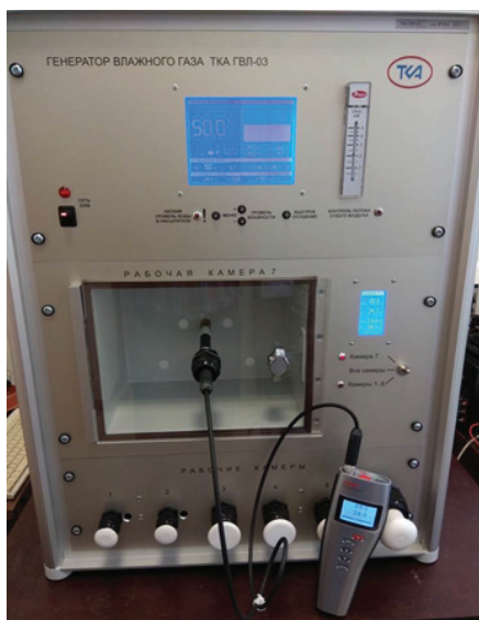
Рис. 8. Расположение измерительного зонда контрольного термогигрометра в рабочей камере № 7 генератора «ТКА-ГВЛ-03»
